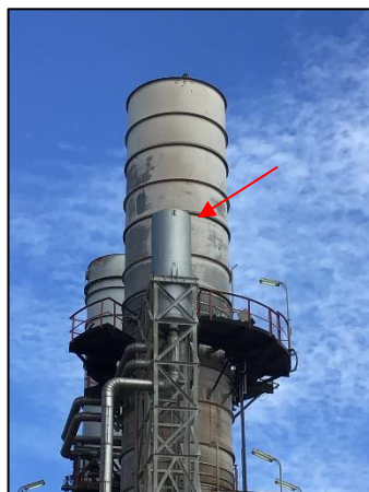
รูปที่ 2-6 อุปกรณ์ลดเสียง (Silencer) ที่ GTG-3
